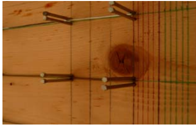
Εικόνα 9:Γραμμική Διαστολή Fe και αλφακά για \theta=210^{\circ}\text{C}-\Delta t=20 \text{ min}
