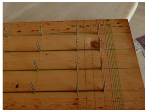
Εικόνα 3,4: Πειραματική Διάταξη σε θερμοκρασία περιβάλλοντος(21°C) -Αρχικό Μήκος l_0 των συρμάτων
