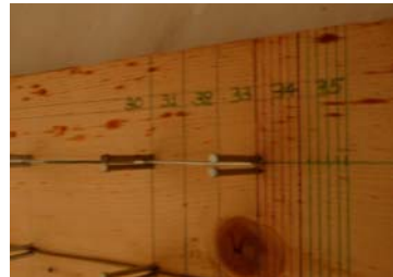
Εικόνα 10:Γραμμική Διαστολή Fe και αλφακά για \theta=210^{\circ}\text{C}-\Delta t=60 \text{ min}
