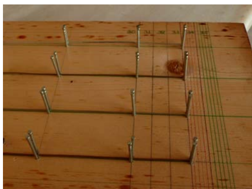
Εικόνα 3,4: Πειραματική Διάταξη σε θερμοκρασία περιβάλλοντος(21°C) -Αρχικό Μήκος l_0 των συρμάτων
